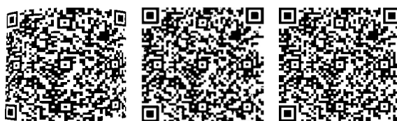
図 9 湾曲 QR コード (左), 修正 (中央), Ground truth (右)
