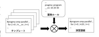
題を自動生成するツールを作成する。対象とする並列プログラミングツールは、代表的なツールである CUDA, OpenMP OpenACC, POSIX thread, MPI, AVX を取り上げ、それぞれの演習ツールと音声付き電子教材を作成し、実運用において教育効果を確かめる。
