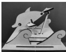
図 14 レーザー加工を用いた組立オートマタ
