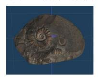
デスクトップ 3D スキャニングシステム (Shinning 3D 社製 EinScan Pro 2X) を用いて 三葉虫(左)やアンモナイト化石(右)等の地質標本の 3D モデル化を行った . Metasequoia 等の 3D データ編集を用いて修正を施し , 光造形プリンタ Form2 ほかを用いて模型出力を 行った .
