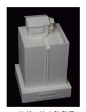
$40 \times 40 \times 60$ cm ほどの地中熱利用システムの模型が大きくて運搬が不便であるため,デスクトップ 3D スキャニングシステムや CAD ( 3D Builder ) を用いて手のひらに乗る 1/8 サイズモデルを作成し,熱溶融積層型 3D プリンタで出力し,イベント等での展示・説明に使用した.
