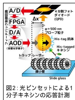
図2: 光ピンセットによる1分子キネシンの応答計測
