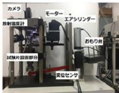
図2:摩擦実験装置の模式図(左)および写真(右)。
