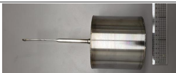
(a)S45C 一般鋼の内圧試験体
