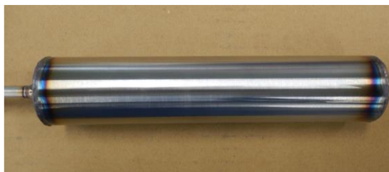
(b)T91 鋼による内圧試験体
