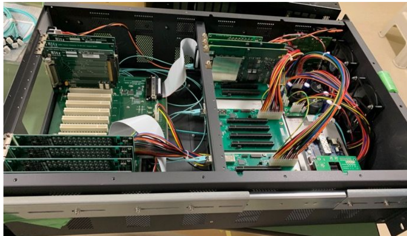
図 4: 新規設計の信号入出力のための拡張ボックス。デジタルアナログコンバーター、アナログデジタルコンバーターなどを大幅に追加できる。
