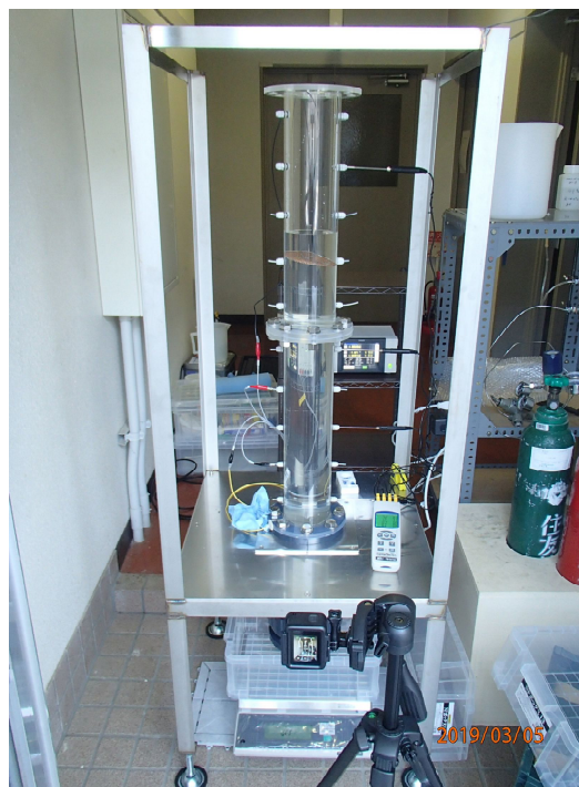
図 1: 製作したカラム実験装置。10cm 毎に電極および温度センサーを挿入できる。水位の低下速度はカメラにより測定する。バルブの開閉により電子天秤の上に排水し、その重量変化と水位の低下速度から透水係数を見積もる設計になっている。
