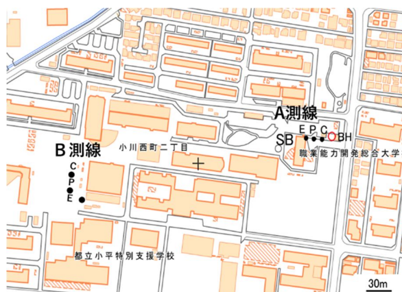
図3 測定位置 北緯 35° 44' 19" 東経 139° 27' 41" 職業能力開発総合大学校内。BH: 検証用ボーリング孔削井の位置、SB: 測定に用いた A 種接地極を有する鉄筋コンクリート製校舎、E: 接地電極端子、P: 電位補助電極、C: 電流補助電極 (国土地理院(2021)に加筆)。
