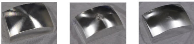
(a) 基準面 (b) 等高線加工後 (c) 走査線加工後 図7 凸型球面加工後の形状
