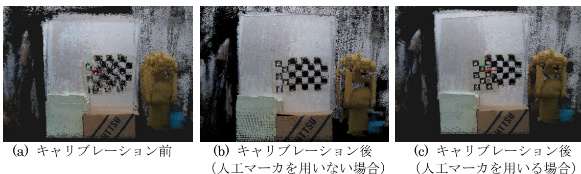
図 10 RGB-D カメラを用いた SKCLAM による地図作成
