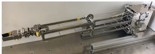
図3 可変把持力・重力補償機構
