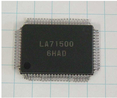
図1 本研究で開発された世界最大級のアナログLSIとそのレイアウト図
