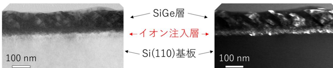
図 1 イオン注入基板上に形成した SiGe の透過型電子顕微鏡像の例
