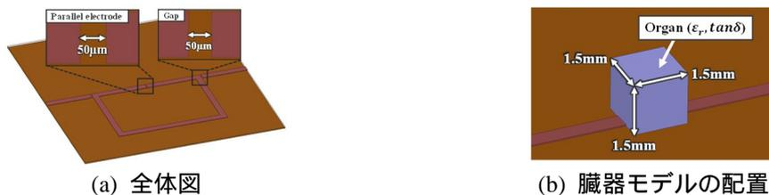
図 3 リング共振器型電極の概要
