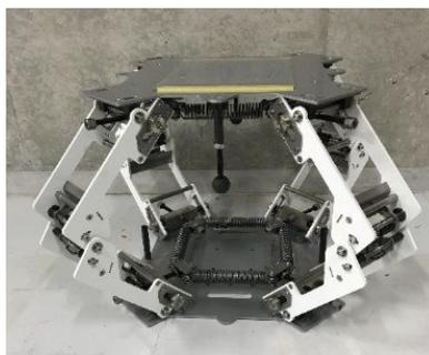
図 4-3-1 リンク機構による同調型鉛直免震機構の試験装置
