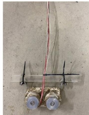
写真-1 超音波振動子(振動子2個)
