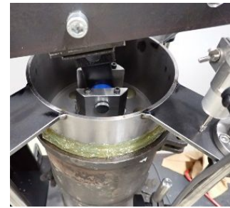
(c)加圧蓋からの排水の様子
