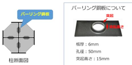
図6 バーリング鋼板(機械的ずれ止め)
