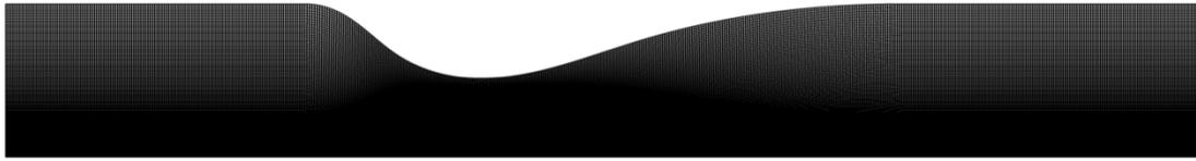
Fig. 3: 高精度数値流体計算 (LES) に用いたディフューザー形状
