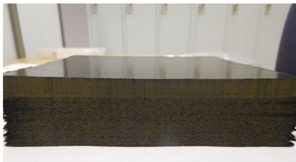
図6 オートクレープで試作した傾斜機能型アプレータの切断面
