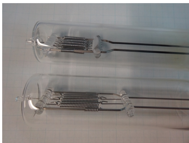
図 2: (上) 従来の 2 層構造のフィラメント, (下) 新
