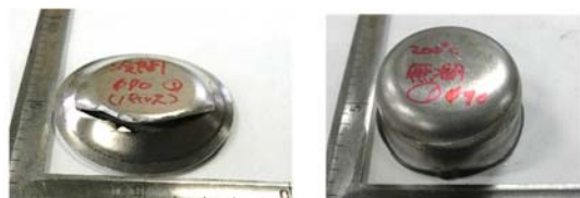
(a) 冷間 絞り比1.46 ( D = 70 \text{ mm} ) (b) T = 200^\circ\text{C} 絞り比1.88 ( D = 90 \text{ mm} ) 図7 冷間および T = 200^\circ\text{C} の無潤滑で深絞り加工された容器
