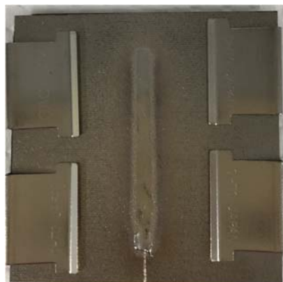
図 1 レーザ照射後の SiC/SiC 平板とジルカロイ平板との接合体の外観写真
