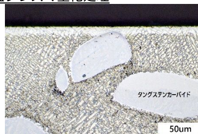
図1 ステンレス鋼/タングステンカーバイド複合材料の窒化処理後の断面組織写真
