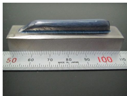
図5 ステンレス合金鋼/タングステンカーバイド積層造形物
