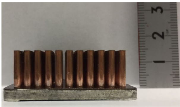
図7 熱間鍛造成形されたCu/Al重ね板の一例
