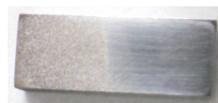
図3 右半分を超純水に30分浸漬した鉄基板の腐蝕。浸漬後取り出して乾燥し酸性雰囲気下で5日間放置後。浸漬した右側の方が腐蝕は遅い。
