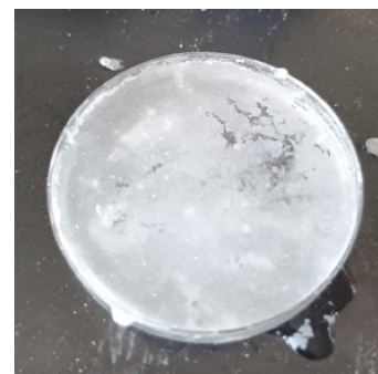
図 4 水の上に自立的に薄膜を形成する h-BN
