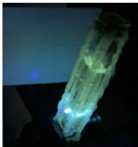
図 2 作製した体積ホログラフィック光学素子と回折光
