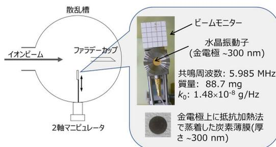
図1 実験装置の概念図。2軸マニピュレータ先端部の写真も併せて示してある。
