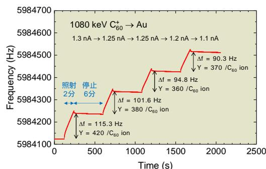
図2  $C_{60}^+$ 照射に伴う水晶振動子共鳴周波数の時間変化。2分照射、6分停止を4回繰り返した。照射前後の周波数変化とそれから求めたスパッタリング収量も示す。
