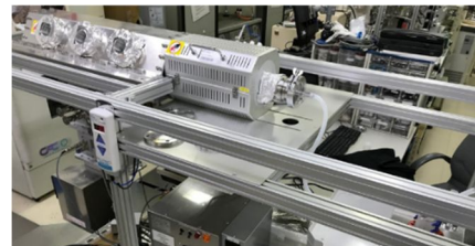
図7 下流側に設置された酸化触媒と赤外線加熱炉
