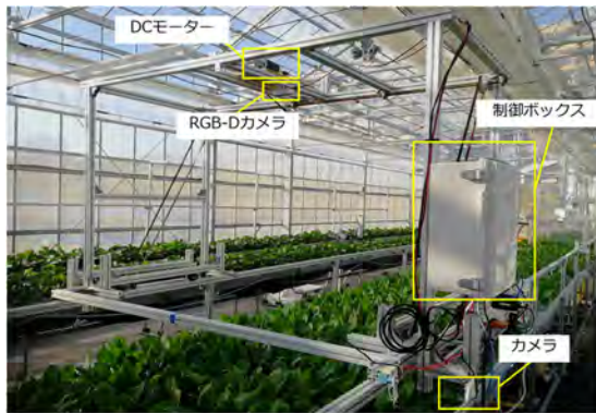
図7 開発した植物フェノタイピングシステム
