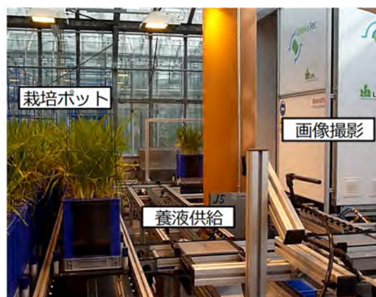
図1ドイツ製の高速植物フェノタイピングシステム
