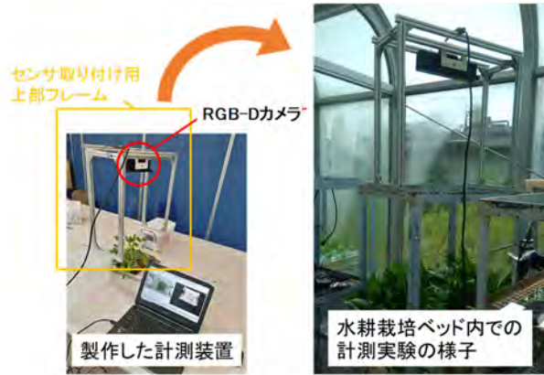
図2 製作した計測装置及び実験の様子
