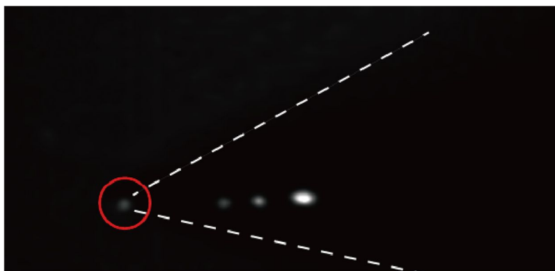
図3: 蛍光色素1分子のイメージング。破線は金電極の概形を示す。赤丸は電極の先端位置を表している。
