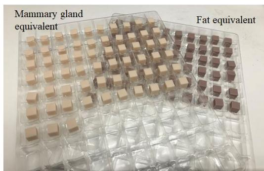
図 1. 乳房の脂肪と等価材質ならびに乳腺と等価材質の 10 mm 厚の板状の樹脂 (ファントムブロック)
