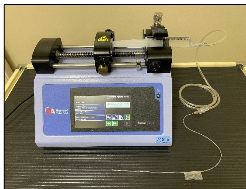
図 1a. シリコンチューブの位置、 b. シリンジポンプ (Model 11-Elite ® , Harvard)
