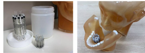
図3 作製した水溶性造影剤入り自家製ミニファントム
