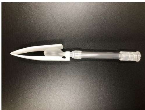
図3. ポリプロピレン樹脂製の測定治具
