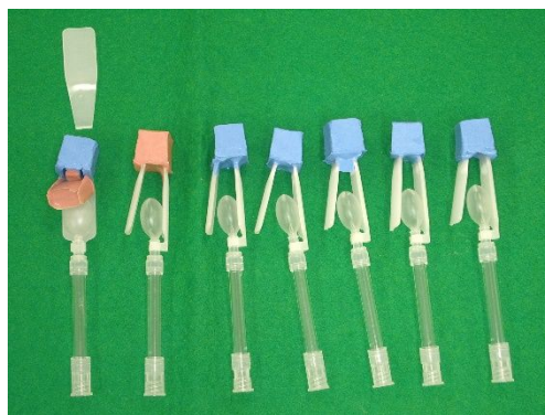
図4. 測定治具の改変および破損
