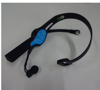
Fig. 1 ヘッドギア型簡易脳波計 MindWave Mobile 2(NeuroSky Co., Ltd., USA)
