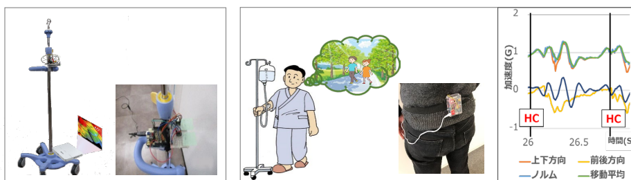
図 8 廊下を楽しく歩くシステム (左: 点滴台+小型プロジェクタ, 左: バーチャル足音)
