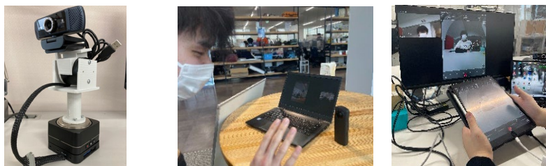
図 6 患者と家族を繋ぐシステムの改良 (左: Keigan モータ利用, 右: 360 カメラ利用)
