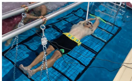
写真1 浮心位置測定の様子
