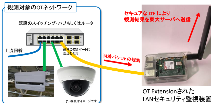
図 6: LAN セキュリティ監視装置の OT Extension
