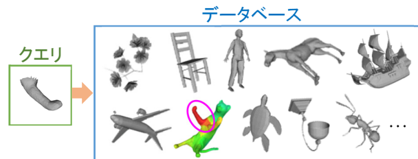
図 1. 部分形状をクエリとして、それと類似した形状を部分として含む全体 3D モデルを検索。
