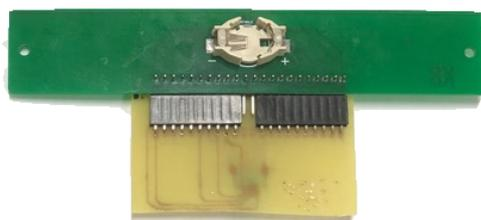
図 3: プラットフォーム基板とセンサコンポーネント基板の接続
