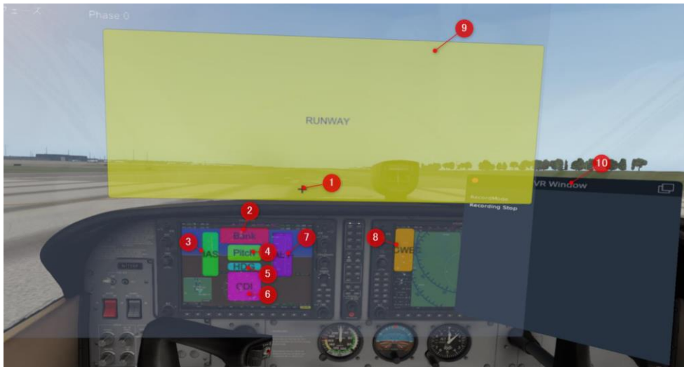
図 1.VIVE PRO EYE をベースとした VR フライトシミュレーション支援システム
