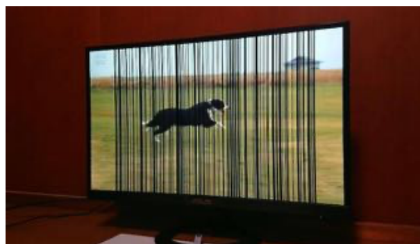
図3:1次元バーコードを用いたフェード イン/フェードアウト効果の例
