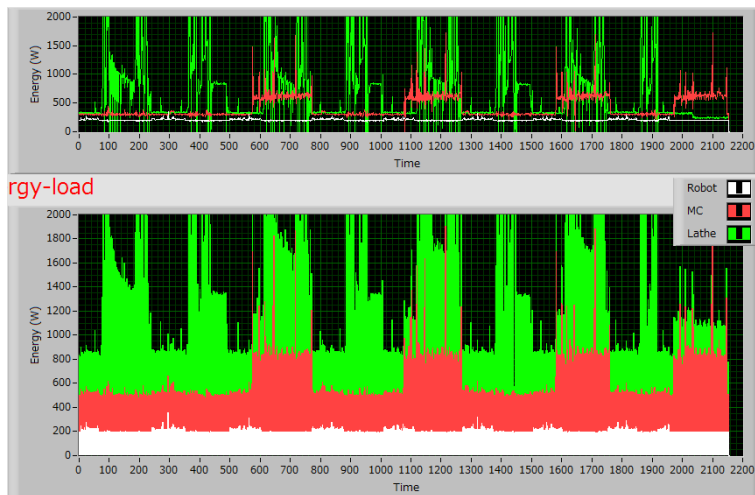
図 3: 計測制御プラットフォームによるシステム消費電力計測
