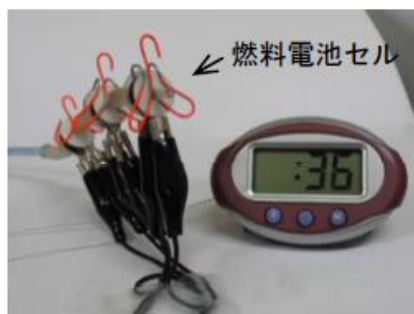
図1 生体高分子電解質を用いた燃料電池による時計の稼働
