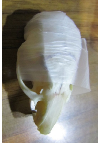
図 3: マウス頭蓋骨内にヨウ素溶液容器を埋設したマウス脳模擬ファントム
