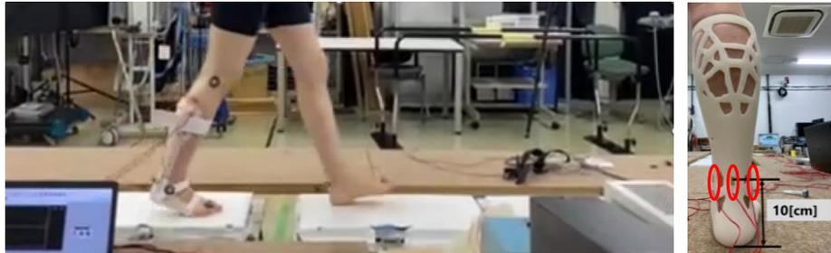
図 8 歩行実験の状況と歪ゲージの設置箇所
