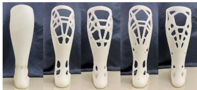
図7 3Dプリンタ出力した短下肢装具(左から元形状, 背屈30%, 背屈40%, 底屈30%, 底屈40%)
