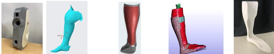
(a) 下肢形状の3Dスキャン (b) 短下肢装具モデル (c) 歩行シミュレーション (d) 3Dプリンタ出力
